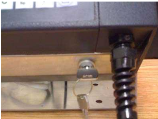
Clé en position AUTONOME, pas de communications avec ordinateur PDV.
