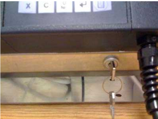
Clé en position NORMAL pour communiquer avec ordinateur PDV.
